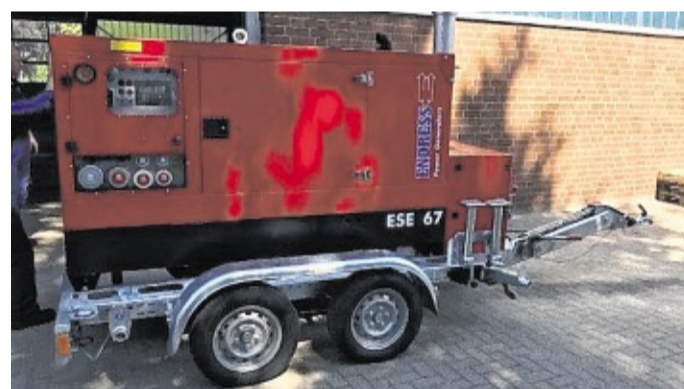
Die Netz-Ersatzanlage der Gemeinde Rellingen bringt eine Leistung von 44 Kilowatt. FOTO: GEMEINDE RELINGEN
