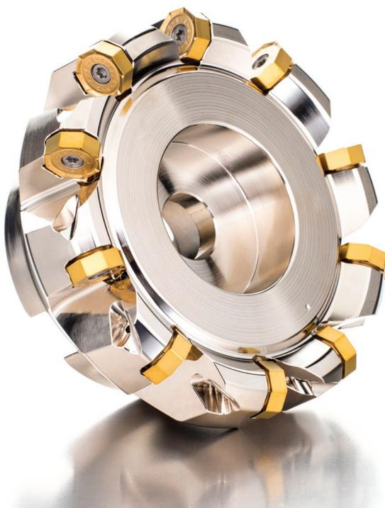
Ein neuer äußerst wirtschaftlicher und produktiver Planfräser, der zwei Arten doppelseitiger negativer WSP verwendet. Wirtschaftliche achteckige ON..06-WSP mit 16 Schneidkanten und ap von 4 mm sowie produktive quadratische SN..17-WSP mit 8 Schneidkanten und ap von 7 mm. Aufsteckausführung ( $\varnothing = 50 - 250$  mm), erhältlich mit unterschiedlicher Zahnteilung. Körper behandelt für längere Standzeit des Werkzeugs.
