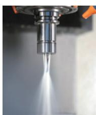
**Hinweis:** Nur das Nennmaß DCONWS kann gespannt werden, mit Kühlkanälen. Einsetzbar bis 21 bar. Um eine optimale Abdichtung zu erreichen, muss das zu spannende Werkzeug auf der ganzen Länge der geschliffenen Bohrung der Spannzange eingespannt werden.
