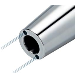
**Nachträgliches Erodieren von 2 Kühlkanalbohrungen**
