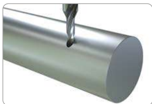
Exzentrische Bohrungen in konvexe Oberflächen.
