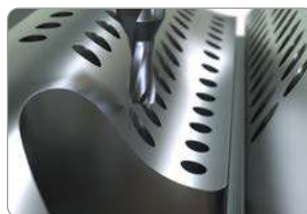
Bohrungen bis 60° Neigungswinkel in konkave Oberflächen.
