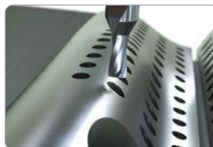
Bohrungen bis 60° Neigungswinkel in konvexe Oberflächen.
